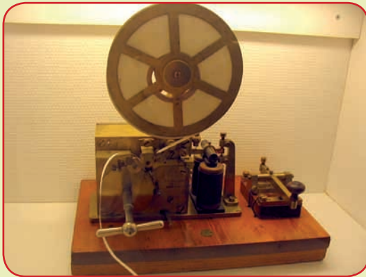
■ El telégrafo es un dispositivo de telecomunicación destinado a la transmisión de señales a distancia, foto Tomasz Sienicki, Dinamarca.
