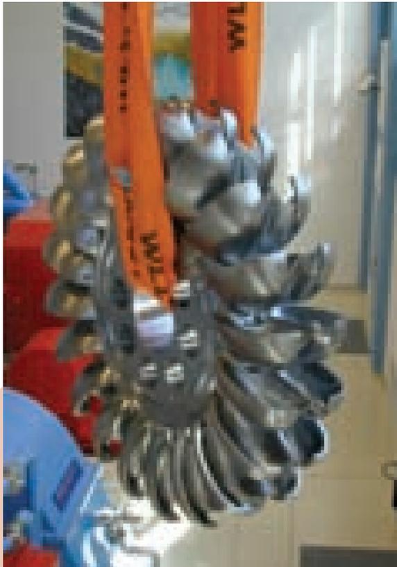
■ Turbina generadora de Pelton para centrales hidroeléctricas.
