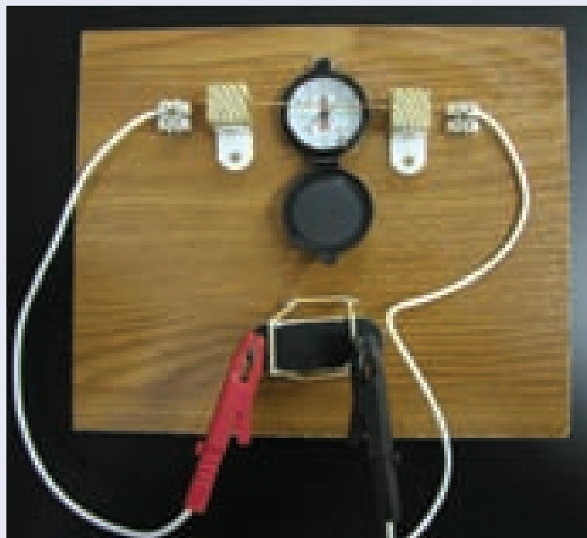
■ H. Oersted descubrió que una brújula se desviaba cuando se encontraba próxima a un hilo conductor de corriente eléctrica.
