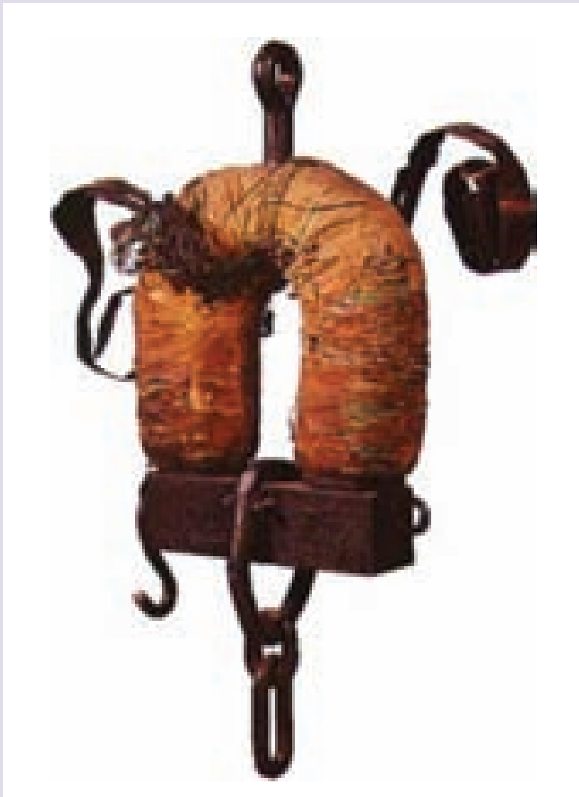
■ Electromagneto creado por Joseph Henry en 1831.
